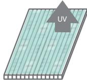
**2** La plancha debe ser instalada de manera que los alveolos corran verticalmente o paralelos a la pendiente.<sup>1</sup>
