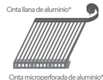
\*Para instalaciones curvas utilizar cinta microperforada a ambos extremos.
